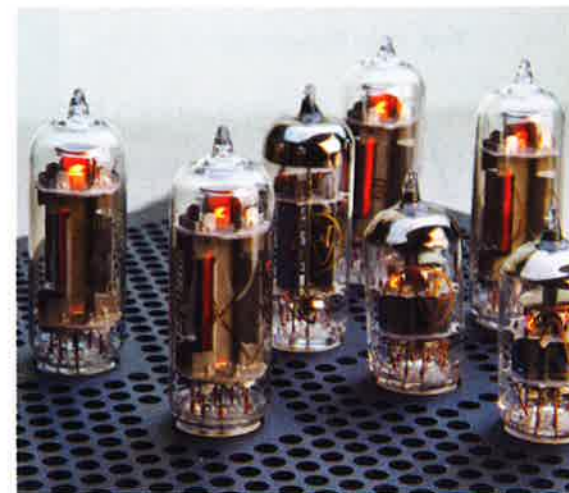
Verkligen helrör: två ECC82, ett ECC99 och fyra 6C19.
