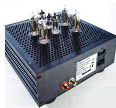
Verkligen helrör: två ECC82, ett ECC99 och fyra 6C19.
